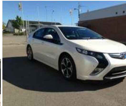
Gaskonverterad Opel Ampera 60 kWh el, 12 kg Biogas
